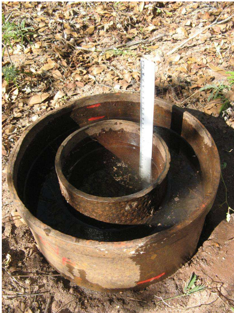
Foto29 - Teste de Infiltração
